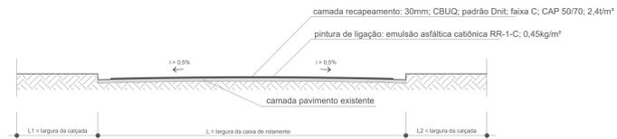
**Detalhe - Seção Transversal Tipo: Recapeamento de Vias Urbanas Locais - Tráfego Leve**
